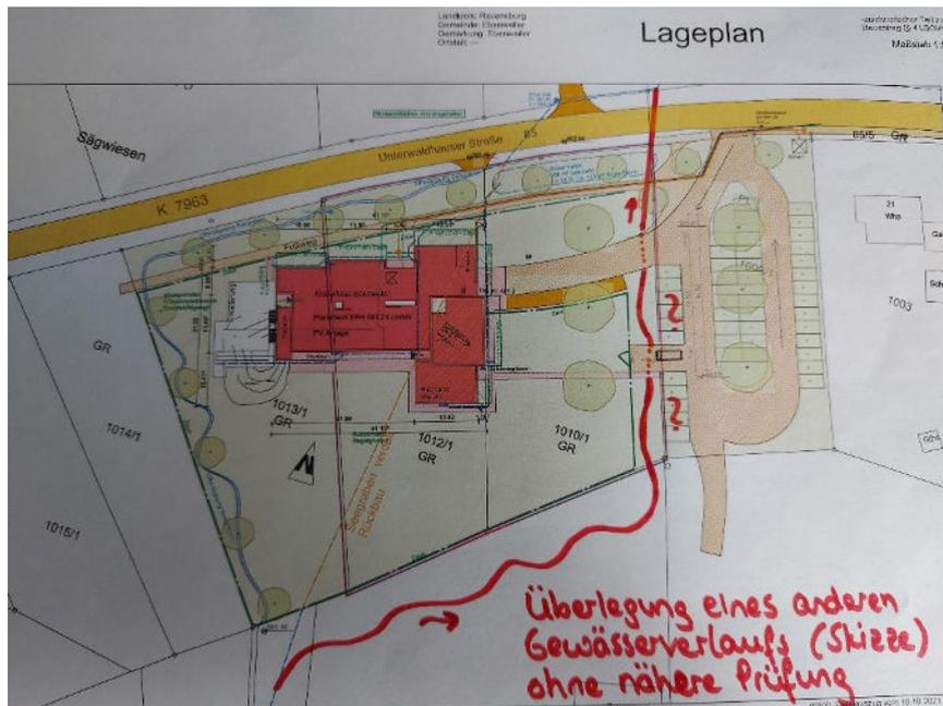
Bild 1: Skizze – Überlegung eines anderen Gewässerverlaufs zur weiteren Prüfung und Abstimmung mit dem Sachgebiet Oberflächengewässer & Grundwasserschutz, Fachbereich Oberflächengewässer
